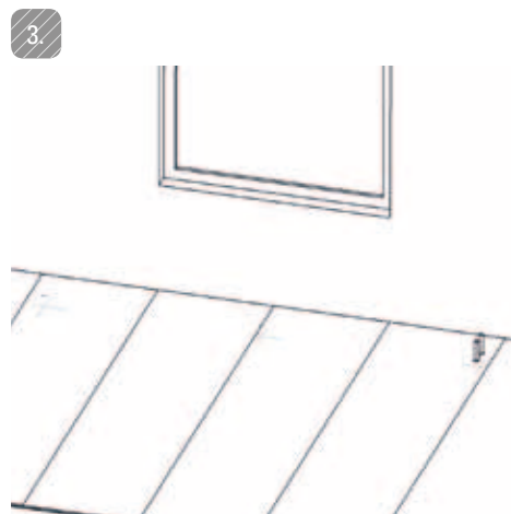
OBR. 5: Vyrvejte otvory pro uchycení těla konvektoru a přiveďte přívodní a odvodní trubku vody do podlahy.
